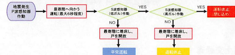
図3 地震時管制運転の流れ
